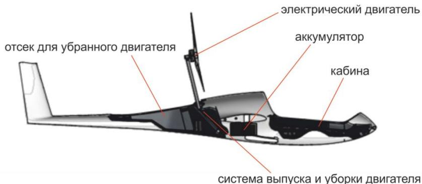
Рис. 2. Компоновка силовой установки Taurus Electro G2
