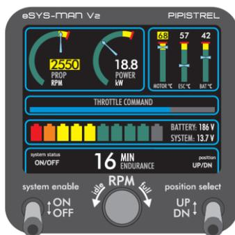
Рис. 5. Внешний вид индикатора системы ESYS-MAN [4]
