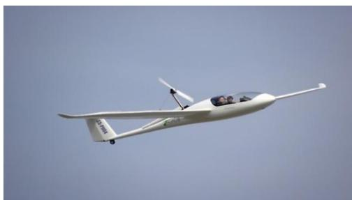
Рис. 1. Мотопланер TAURUS Electro G2 с выпущенным двигателем в полете [3]
